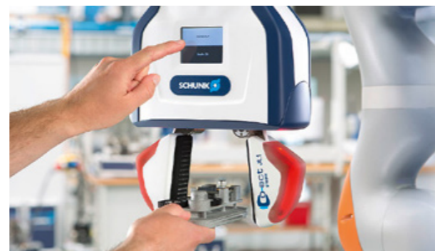
Der SCHUNK Co-act Greifer JL1 ist das weltweit erste intelligente Greifmodul für die Mensch-Roboter-Kollaboration, das unmittelbar mit dem Menschen interagiert und kommuniziert. Bilder: SCHUNK
