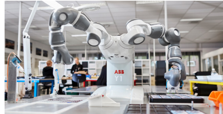
YuMi® der weltweit erste wirklich kollaborative Roboter. Bild: ABB
