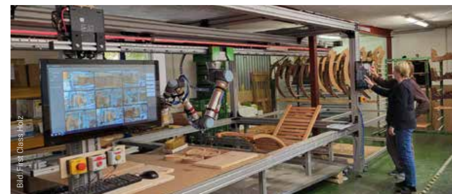
Der Roboter übernimmt künftig die Grundlast und die Mitarbeiter können sich auf die Qualitätskontrolle und die noch nötige Nacharbeit fokussieren. Aufgrund der Auslegung als kollaborierende Roboteranlagen kann dies neben dem laufenden Roboter erfolgen.
