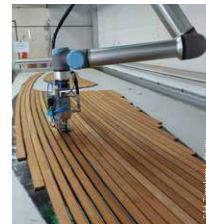
Der Roboter kann das Material vor allem bei längeren Bahnen gleichmäßiger auftragen.
