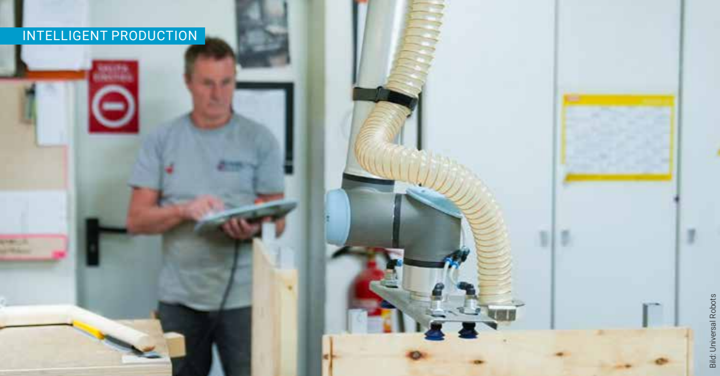
Seit 2020 unterstützen zwei Cobots von Universal Robots den Sitzmöbelhersteller HUSSL bei Pick-and-Place-Anwendungen in der Serienfertigung.
