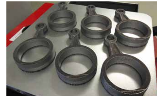
Das Institut für Fertigungstechnik der TU Wien optimiert in additiven Verfahren die Dichte der Bauteile. Bild: IFT TU Wien
