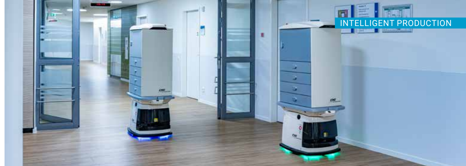
Mit der neuen Navigationstechnologie von DS AUTOMOTION transportiert der Sally Kurier autonom und unfallfrei Laborproben, Dokumente und Medikamente im Krankenhaus. Bild: DS AUTOMOTION
